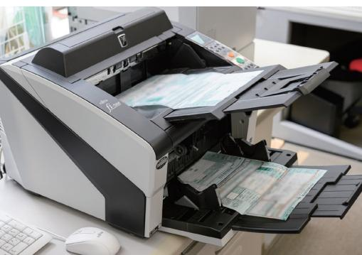
「fi-7800」は毎分110枚・220面の高速スキャンが可能です。また地紋除去などOCRに最適な画像を生成するための機能を備えています。
