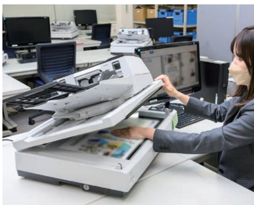
「fi-7700」は上部にADF(左)、下部にフラットベッド(右)を備えたA3対応機です。途中でADFとフラットベッドを切り替えた場合もイメージデータを1ファイルとして保存できます。
