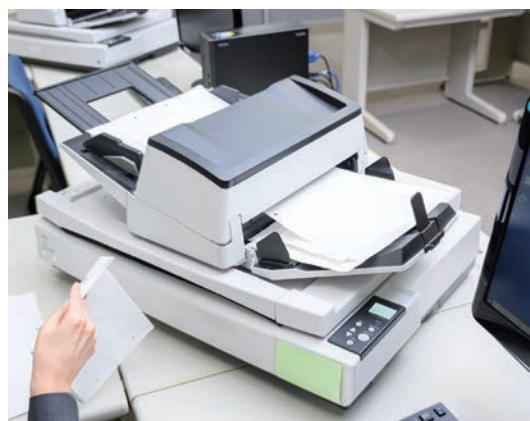
「fi-7700」は上部にADF(左)、下部にフラットベッド(右)を備えたA3対応機です。途中でADFとフラットベッドを切り替えた場合もイメージデータを1ファイルとして保存できます。
