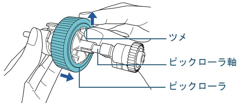
**6** 新しいピックアップラ（2個）を1個ずつ、ピックアップラ軸に取り付けます。
