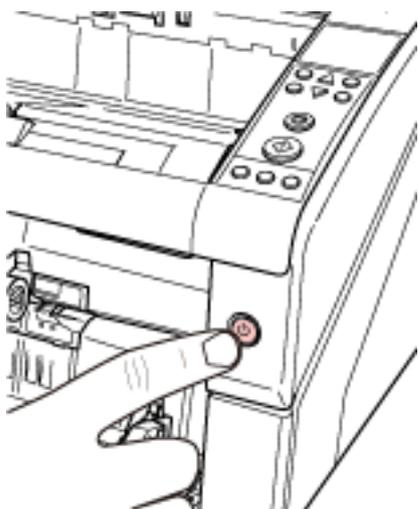
電源が投入され、電源ボタンが青色に点灯します。
