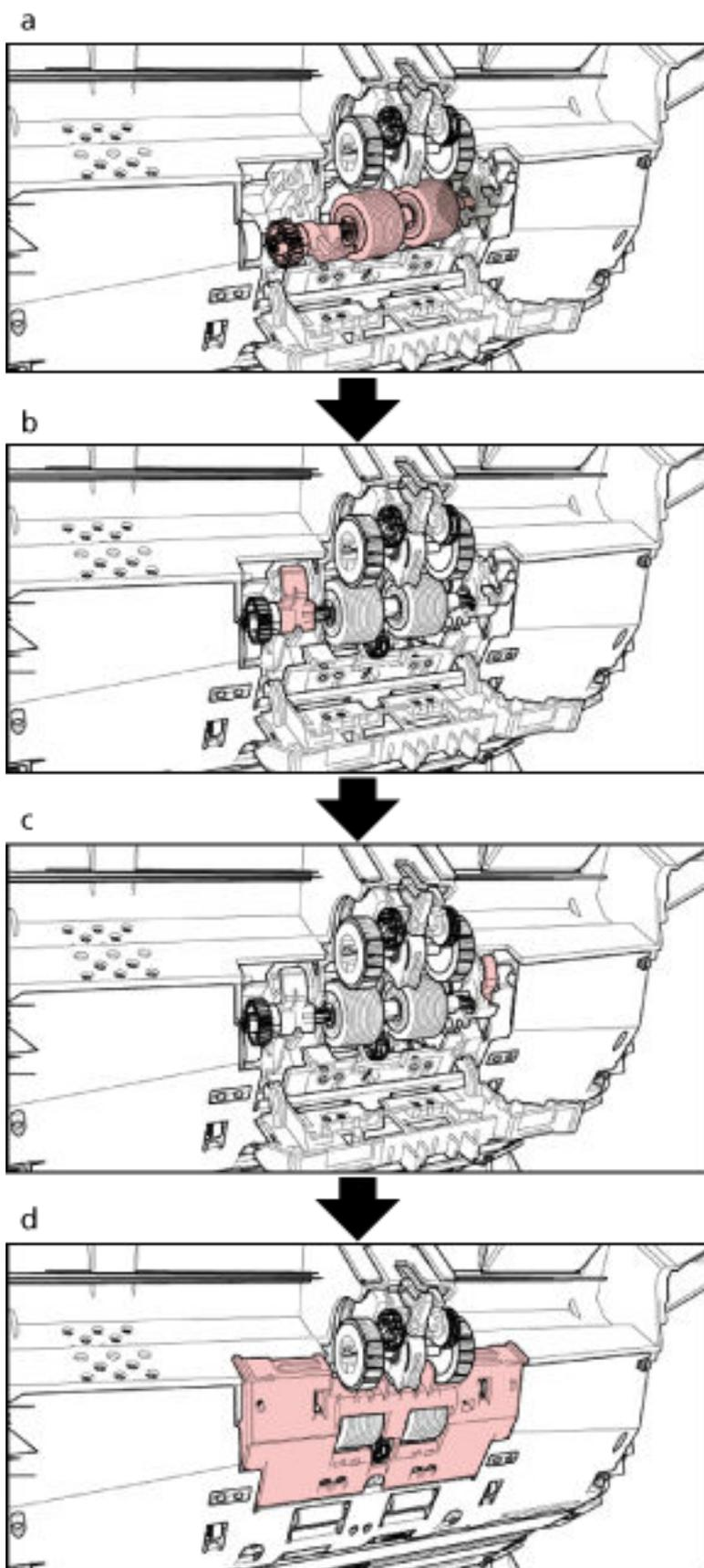
セパレーターローラをスキャナーに取り付ける説明の補足手順を次に示します。
