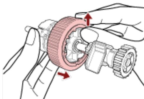
**7 新しいピックローラ（2個）を1個ずつ、ピックローラ軸に取り付けます。**
