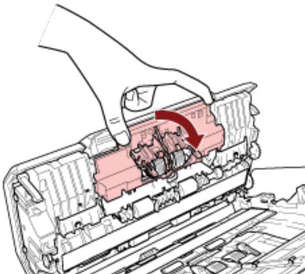
b ブレーキローラを手前に軽く引き出して軸の左側を外し、軸の右側を穴から抜き取ります。
