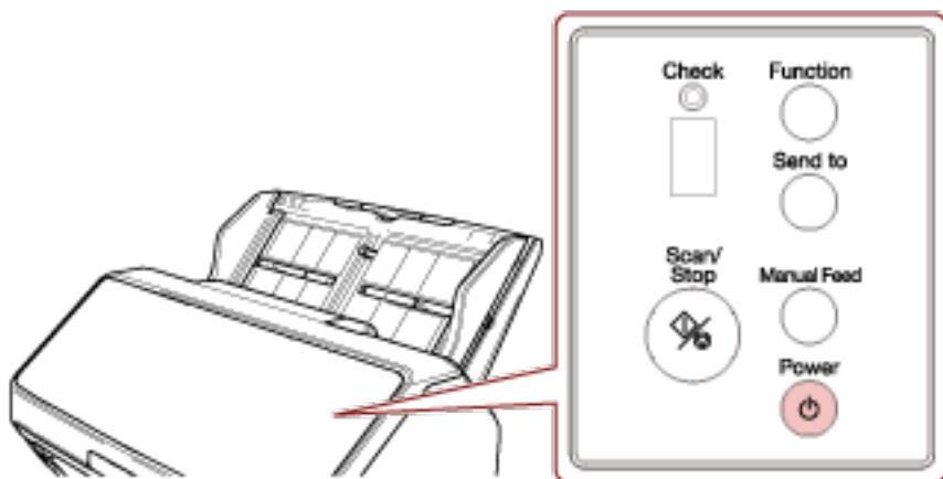
電源が投入され、[Scan/Stop] ボタンが緑色に点灯します。
