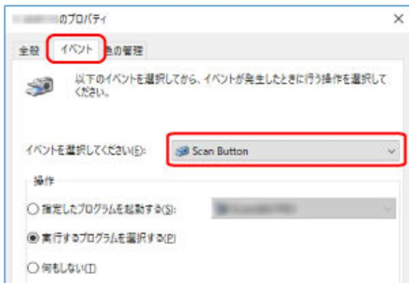
スキャナーの読み取りを開始するボタンを、コンピューターで設定したボタンに切り替える方法を次に示します。
