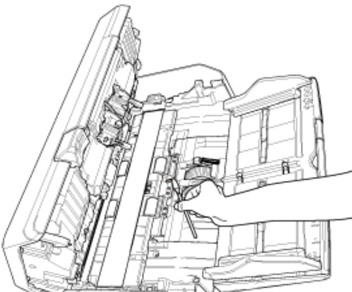
**5 手で回転させながら清掃するフィードローラー（2か所）****6 手で回転させながら清掃する排出口ローラー（2か所）**
