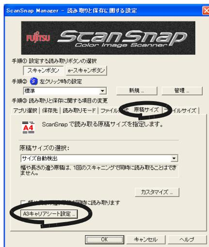
3. 「A3 キャリアシート設定」の画面で、[実行モード] を「見開き画像を出力します」にして [OK] ボタンをクリックします。
