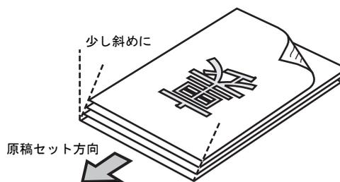
ScanSnap Manager の「読み取りと保存に関する設定」画面で、[読み取りモード] タブ→ [オプション] の「原稿を上向きにしてセットします」にチェックが入っている場合は、原稿表面を上向き、後端を原稿セット方向にしてください。
