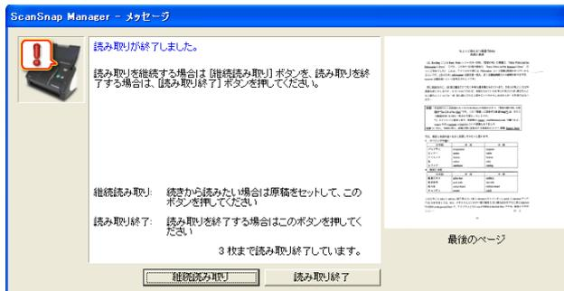
続けて読み取る場合は、ScanSnap に原稿をセットして、[継続読み取り] ボタンをクリックします。
