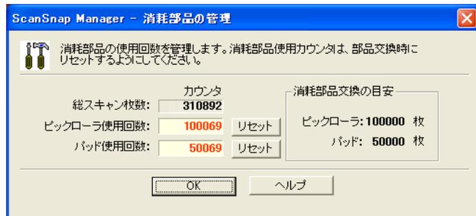
「消耗部品交換の目安」を目安にして、消耗部品の交換をしてください。
