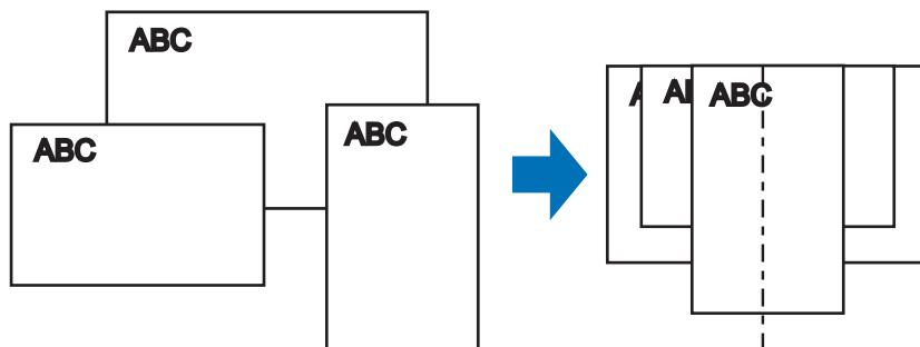
**2. 原稿を給紙カバー（原稿台）の中央にセットします。**
