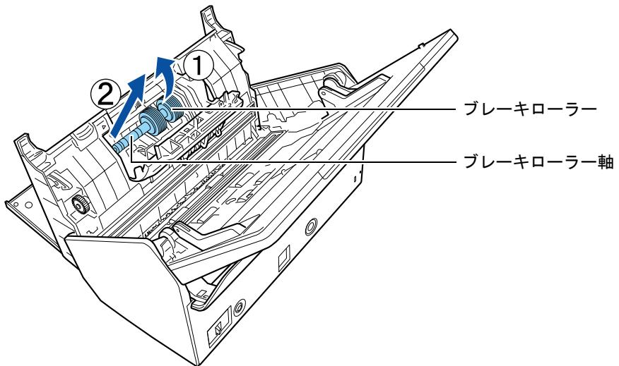
**3. ブレーキローラーを、ブレーキローラー軸から取り外します。**
