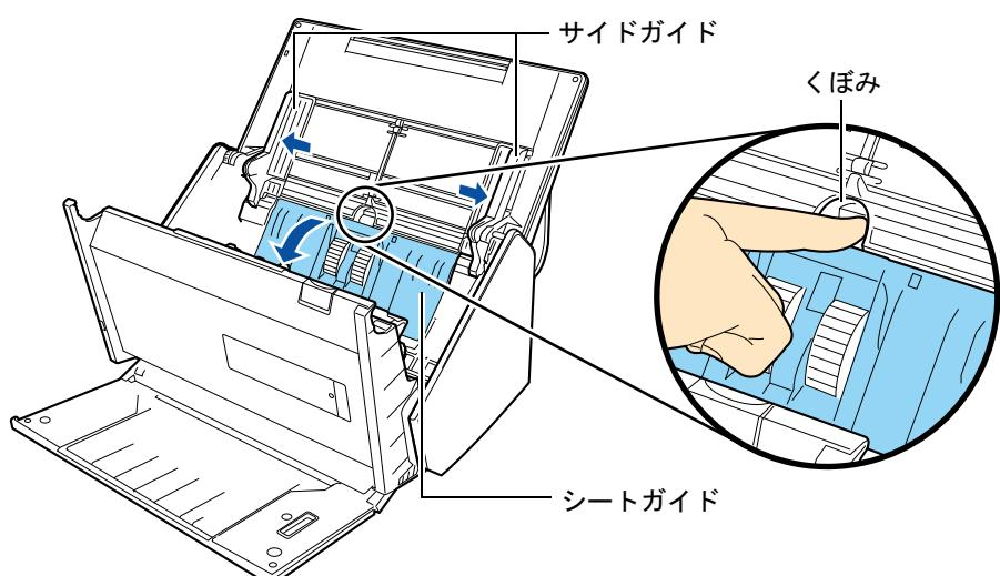
2. ピックローラーのレバーを、矢印の方向に回転させます。
