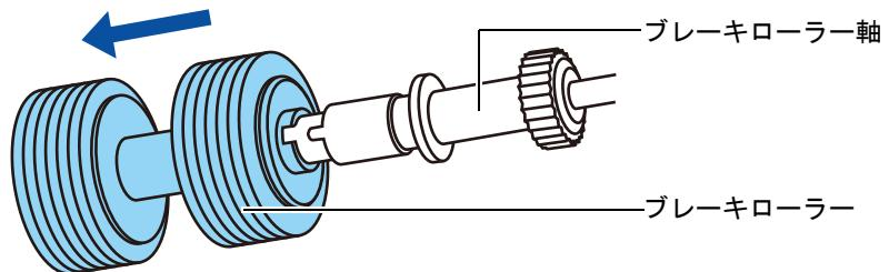
**4. 新しいブレーキローラーを、ブレーキローラー軸に取り付けます。**
