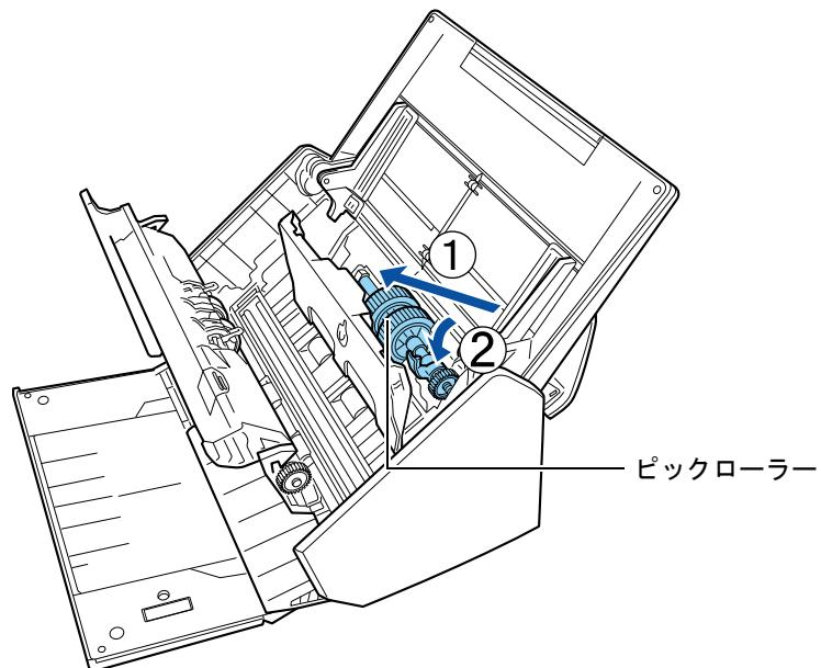
5. ピックローラーのレバーを、矢印の方向に回転させます。
