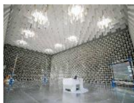
10m 法電波暗室
