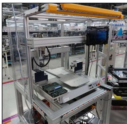
ネジ締めロボット(外観)
