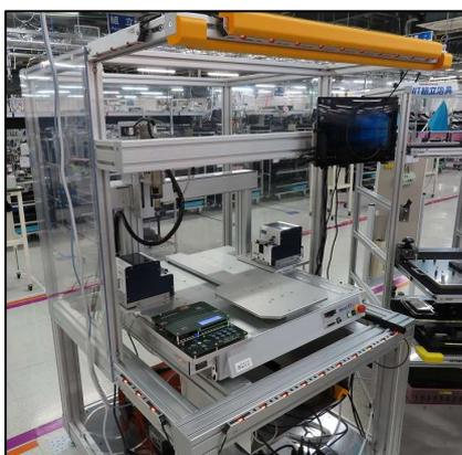
ネジ締めロボット(外観)
