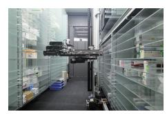
処方データが監査を 通ると、ロボットが全 自動でピッキングを行 います。目にもとまら ぬ速さです。
